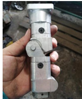
Figura 10: Prótesis de rodilla mecánica manufacturada en fresadora CNC y torno manual.
