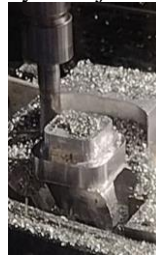
Figura 8: Maquinándose en Fresadora Promil 8000
