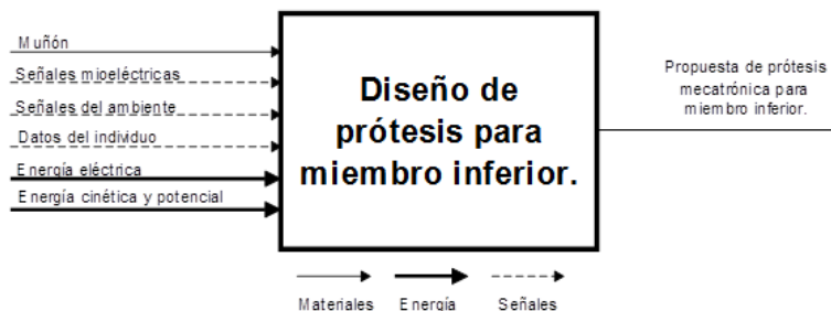
Figura 1: Esquema de caja negra, planteada para el diseño de la prótesis para miembro inferior.
