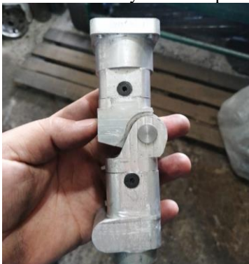
Figura 10: Prótesis de rodilla mecánica manufacturada en fresadora CNC y torno manual.
