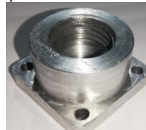
Figura 9: Acabado de pieza con torno manual
