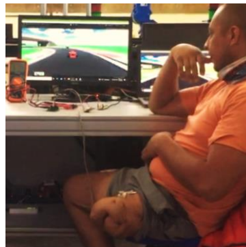
Figura 18: Prueba de la tarjeta EMG con videojuego de rehabilitación en persona con amputación transfemoral
