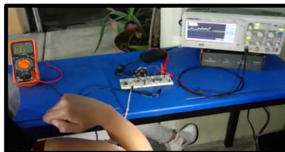
Figura 8 Etapa de convertidor A/D con ADC536
