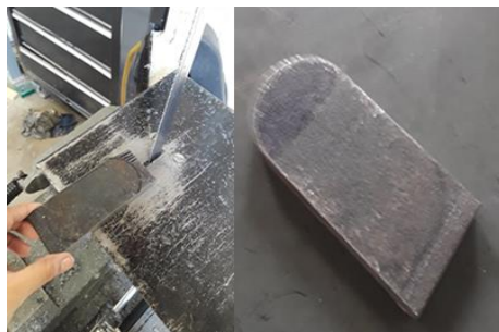
Fig.10: Proceso de corte en la placa de acero 4140.
