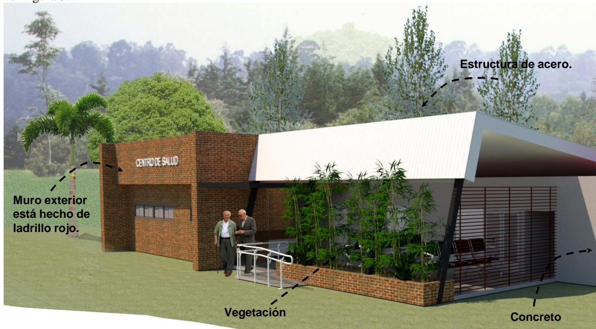
Ilustración 5 Vista esquemática elementos constructivos prototipo.
