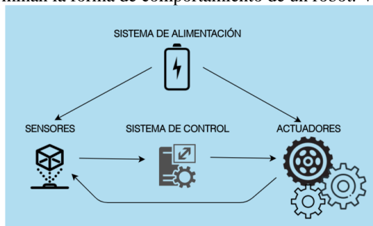
Figura 1: Componentes generales de un robot móvil (Elaboración propia).
