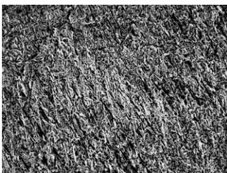
Figura 2: Imágenes 500x de los electrodos rayado con una lijadora BLACK + DECKER modelo SS200 con papel de lija P50, (microscopio marca Digital Microscope Magnificación)
