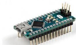
Figura 4: Placa de desarrollo Arduino Nano (*Arduino CO.*)
