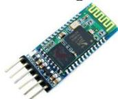
Figura 8: Módulo de bluetooth (geekfactory CO).
