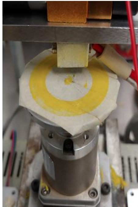
Figura. 4. Prueba de extrusión de filamento de Policaprolactona, imprimiendo un patrón de círculos concéntricos.
