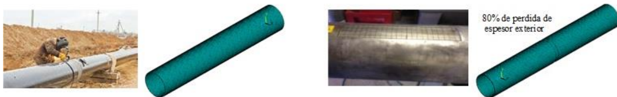
Figura 2. Ducto de 24" de diámetro y espesor de 0.5", a la derecha se muestra la pérdida de metal del 80%.
