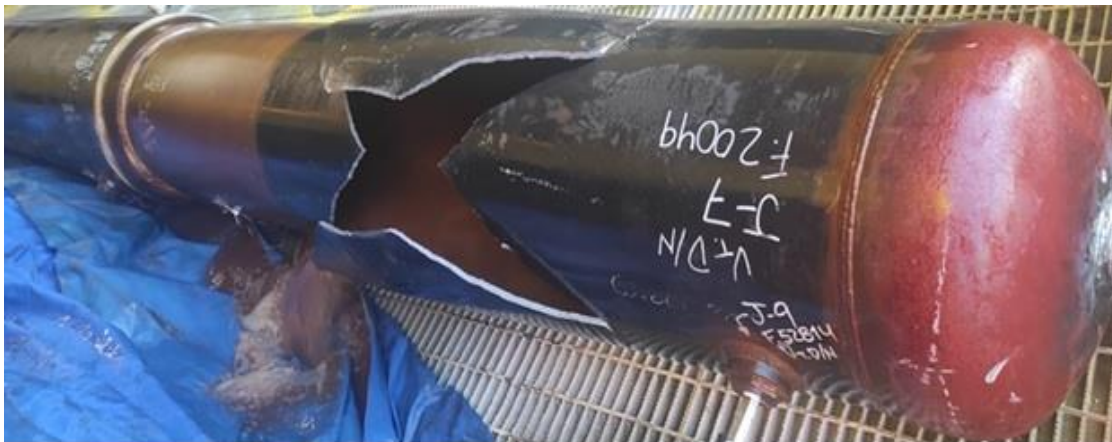
Figura 8. Envoltura con polímero en el espacio anular, fractura la sección no reparada.
