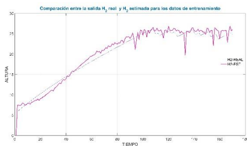
Figura 11 Comparación entre la salida H_2 real y H_2 estimada para los datos de entrenamiento.
