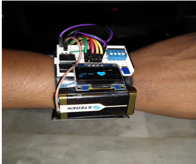
Figura 6 prototipo #DOS oxímetro glucómetro.
