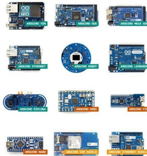
**Ilustración 2. Tipos de placas Arduino existentes**
