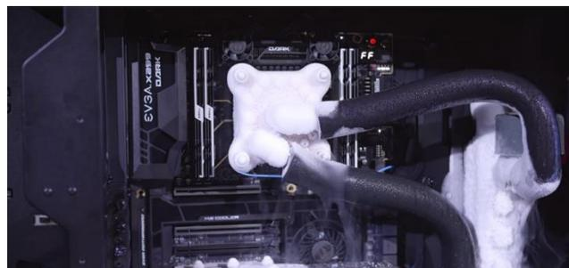
Figura 7. Refrigeración por criogenización.
