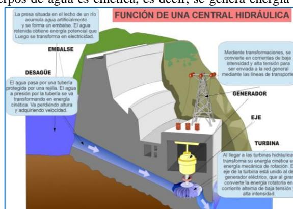
Figura 14. Funcionamiento de una central hidroeléctrica (Paula, s.f.)
