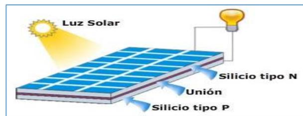
Figura 7. Composición de una celda solar (Tecnología, s.f.)
