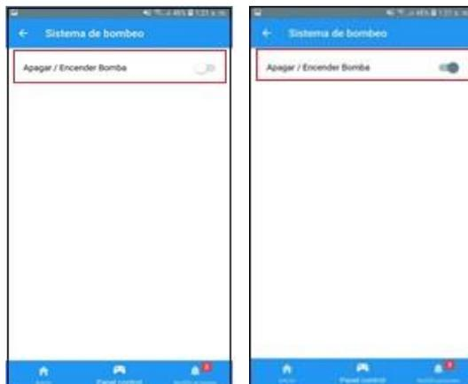
Figura 6. Botón de encendido/apagado de la bomba dentro de la aplicación móvil.
