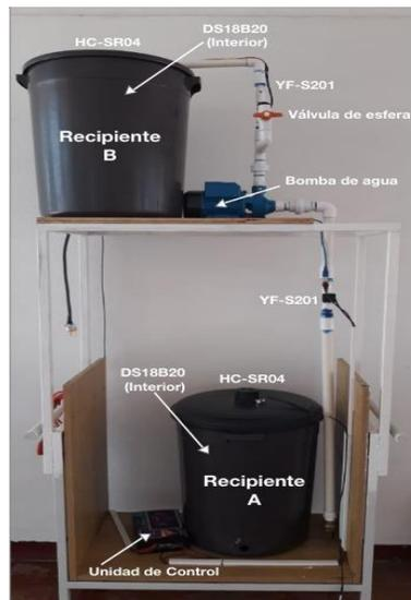
Figura 4. Prototipo del Laboratorio remoto de mecánica de fluidos.
