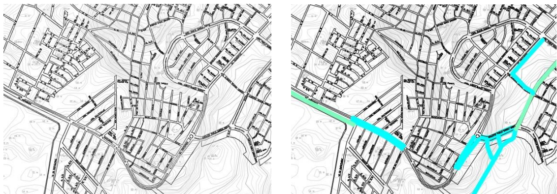
Figura 7. Curvas de nivel, áreas de inundación (color cian) y canales naturales (color verde) en la colonia de
