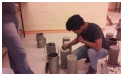
Fig. 4.- descimbrado y etiquetado de cilindros
