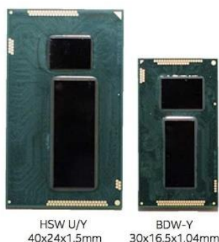
Figura 1. Comparación de tamaño de procesador de 22nm y procesador de 14nm. Fuente: Tomada del sitio http://www.xataka.com
