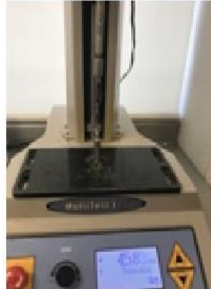
Figura2: Muestra la Máquina de Prueba Universal en procedimiento de tensión a una velocidad de 5 mm/min.
