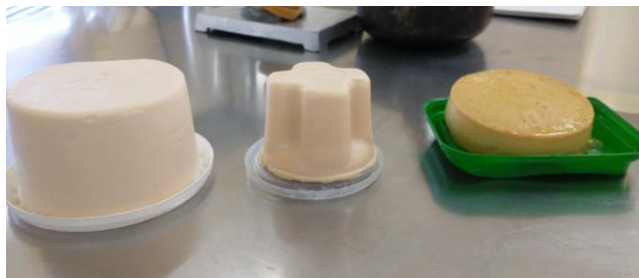
Ilustración 1. Jabones obtenidos mediante el proceso de saponificación en frío.
