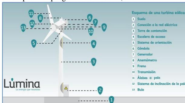
Figura 5. Partes de una turbina (Lumina, s.f.)
