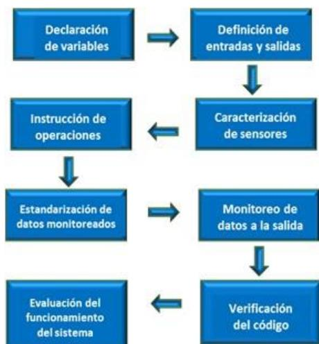
Fig. 7.- Diagrama de flujo de programación
