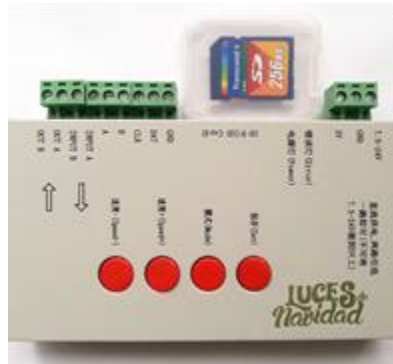
Figura 1. Controlador de led pixel que se utilizara pala la elaboración de la pantalla
