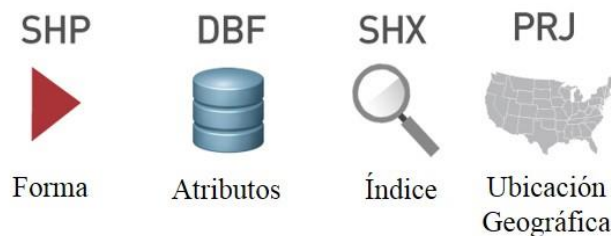
Fig.2.Archivos necesarios para una capa de información en los Sistemas de Información Geográfica tomada de https://www.kaggle.com/code/shivamb/2-automation-pipeline-integration-processing/notebook
