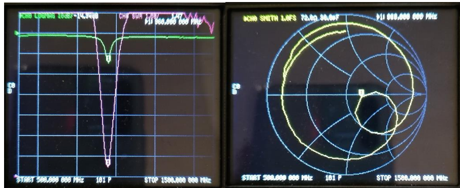
Figura 5. Medición de los parámetros de la antena con nano VNA VSWR, retorno de pérdidas (lado derecho) y carta de Smith (lado izquierdo). Fuente: Propia.
