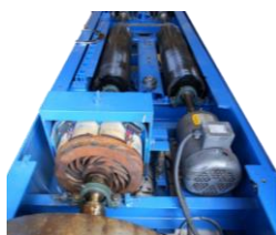
Figura. 10. Dinamómetro de chasis marca Mustang, modelo MD-100-M-2WD.
