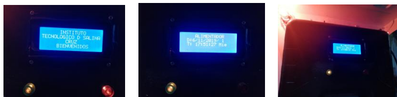
Figura 9. Operación del sistema a) Mensaje de bienvenida. b) Información de fecha, hora y día. c) Indicador de activación del alimentador.
