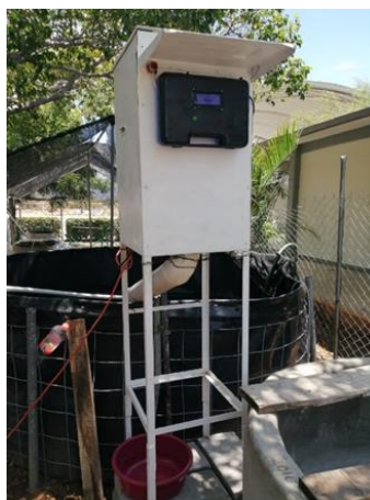
Figura 8. Sistema de alimentación automatizado instalado en los estanques del Instituto Tecnológico de Salina Cruz.
