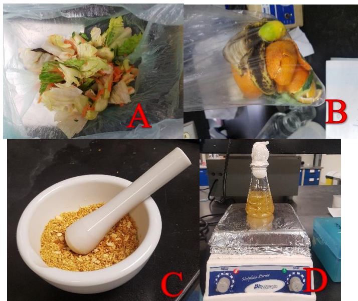
Figura 1: A) Primera recolección de frutas y vegetales de desecho. B) Segunda recolección de desechos de frutas y vegetales. C) Trituración de una parte de la materia orgánica seca. D) Proceso de extracción calentado y centrifugando.
