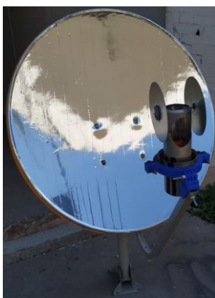
Figura 6. Motor Stirling acoplado al colector solar.
