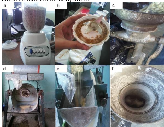
Figura 2. Equipo para el triturado: a) Licuadora de 5 vel, b) Cuchillas de 4 aspas, c) y f) Molino manual, d) y e) Molino de nixtamal eléctrico.
