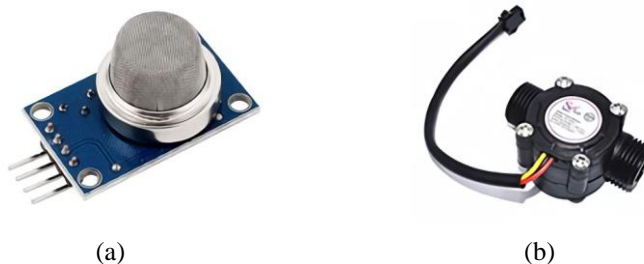
Figura 2. Sensores: a) Sensor analógico para la presencia de gas LP, b) Sensor digital para el flujo de agua.
