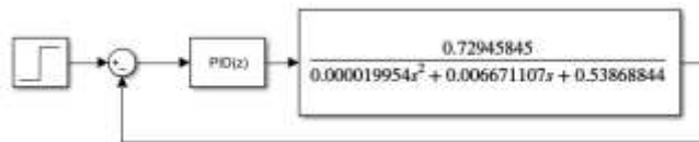
Figura 5. Conexión Lazo cerrado de controlador PID y modelo matemático del motor de CD
