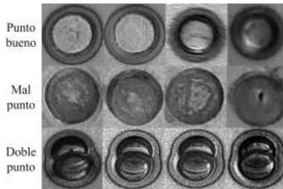
Figura 3. Defectos de RSW.
