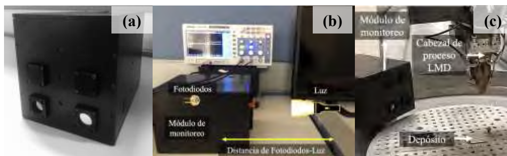
Figura 5. (a) Módulo de monitoreo, (b) pruebas controladas, (c) Pruebas en celda LMD.
