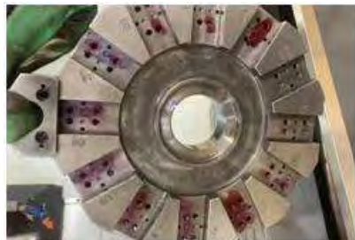
Figura No. 3: Torreta dañada Fuente: Elaboración propia
