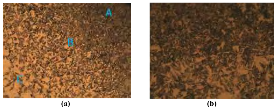
Figura 4. Micrografía de la sección transversal de la probeta cementada por 6 horas utilizando la mezcla 1 con posterior tratamiento de temple a; a) 10 X y b) 20 X.
