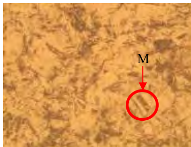
Figura 3. Microestructura del acero inoxidable AISI 304, testigo. donde se observa la presencia de granos poligonales correspondientes a la fase austenítica. 10 X.
