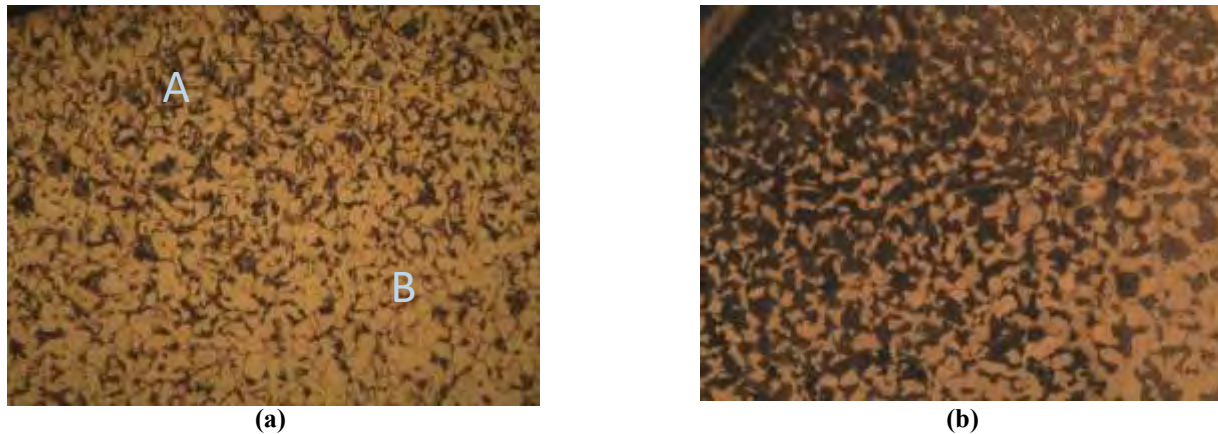
Figura 3. Micrografías de la sección transversal de las probetas cementadas por 6 horas utilizando la mezcla cementante compuesta por; a) 20 % de cáscara de huevo (M1) y b) 100% de carbón vegetal (M2), ambos casos sin tratamientos de temple y revenido.
