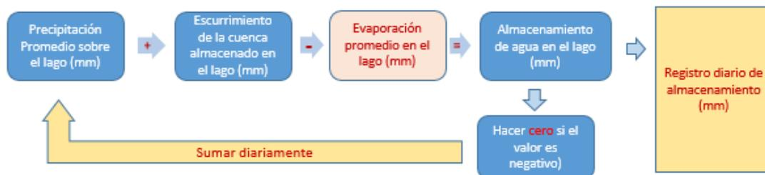
Figura 2. Procedimiento para estimar el almacenamiento del lago expresado en lámina (mm)
