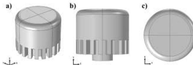
Figura 2. Modelo base de la tapa de burbuja. a) vista isométrica; b) vista frontal; c) vista superior.
