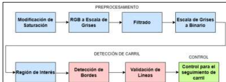
Figura 1. Metodología seguida para el procesamiento de la imagen y la detección del carril.
