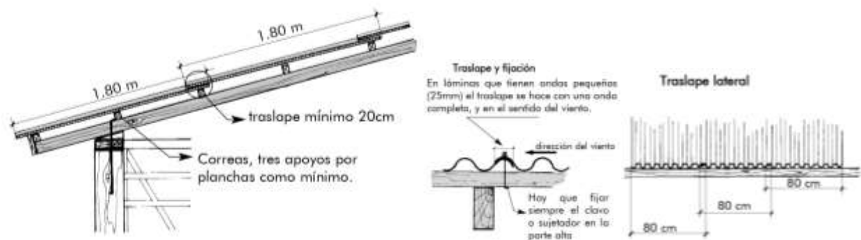
Ilustración 10. Detalles de traslape de cubierta de lámina.
