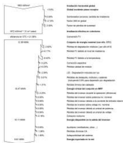
Figura 7. Diagrama de Perdas Az20°@8° de inclinación del arreglo Solar en Monterrey Nuevo León México
