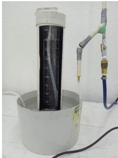
Figura 11 Medidor de producción de Oxihidrógeno por desplazamiento de la columna de agua.
