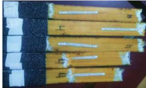
Figura 2. Falla de probetas de material compuesto de matriz epóxica reforzada con fibra de vidrio y tejido de fibras naturales de caña guadua y algodón. (Mazón, 2018)
