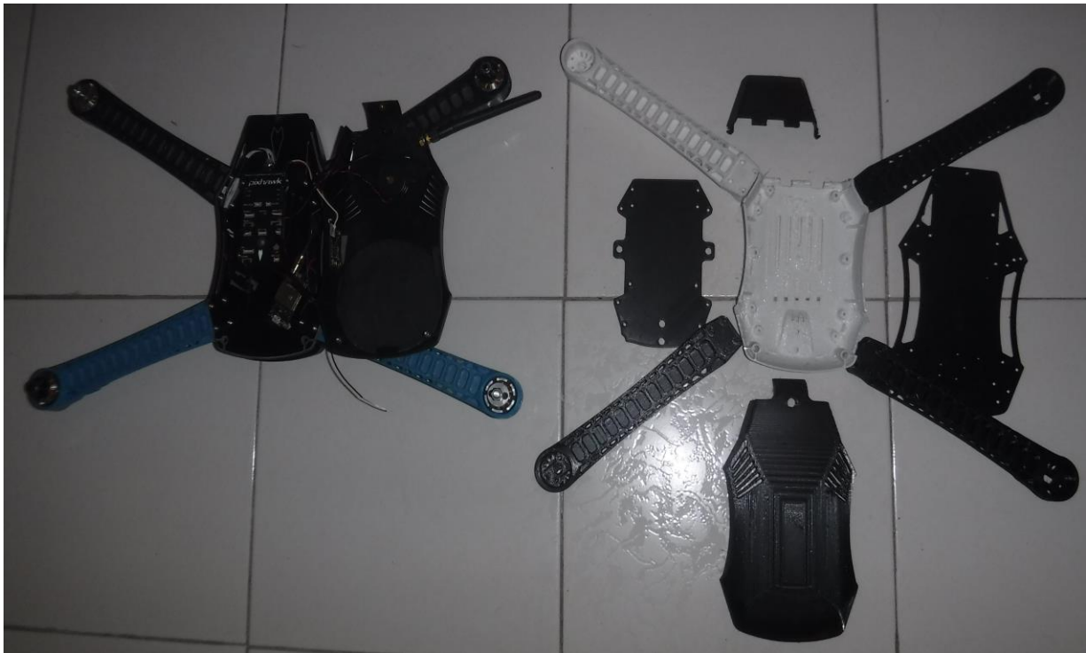
Figura 2. Armazón impreso en 3D comparado con el drone Iris original
