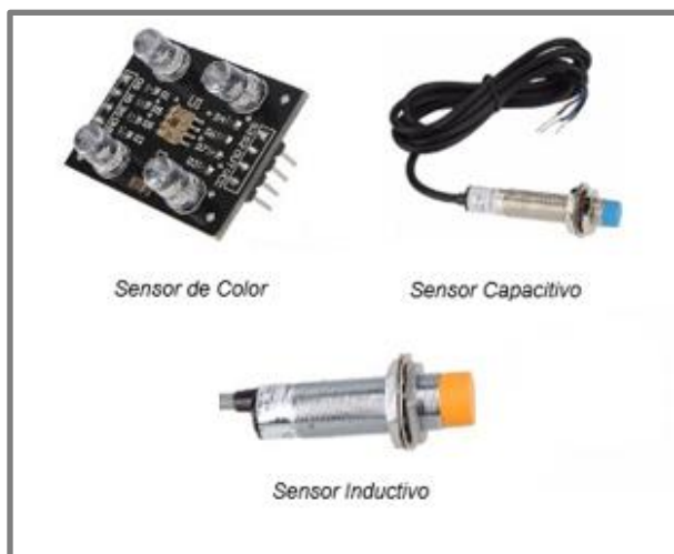
Figura 3. Referencia visual de los sensores que integran el módulo.
