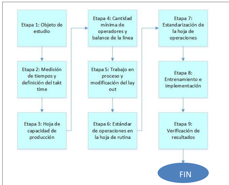
Figura 1. Diagrama de flujo implementación de trabajo estandarizado. Fuente: Improvement based on standardized work (2017).
