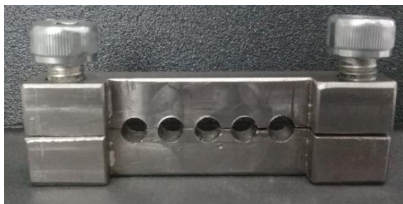
Figura 1.- Molde de acero inoxidable, 4mm de diámetro por 5mm de alto
