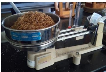
Figura 3. Tamiz y balanza granataria.
