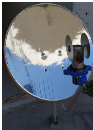
Figura 6. Motor Stirling acoplado al colector solar.
