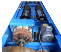
Figura. 10. Dinamómetro de chasis marca Mustang, modelo MD-100-M-2WD.
