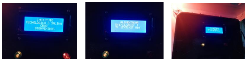
Figura 9. Operación del sistema a) Mensaje de bienvenida. b) Información de fecha, hora y día. c) Indicador de activación del alimentador.
