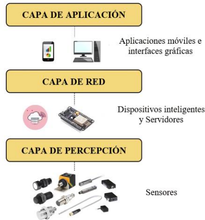
Figura 5. Diagrama a bloques de la arquitectura IoT de tres capas.
