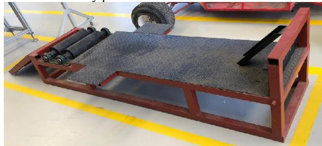
Figura 4. Estructura final del dinamómetro
