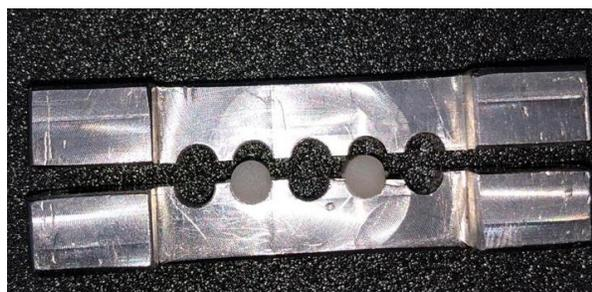
Figura 2.- Apertura del molde, para retirar las muestras
