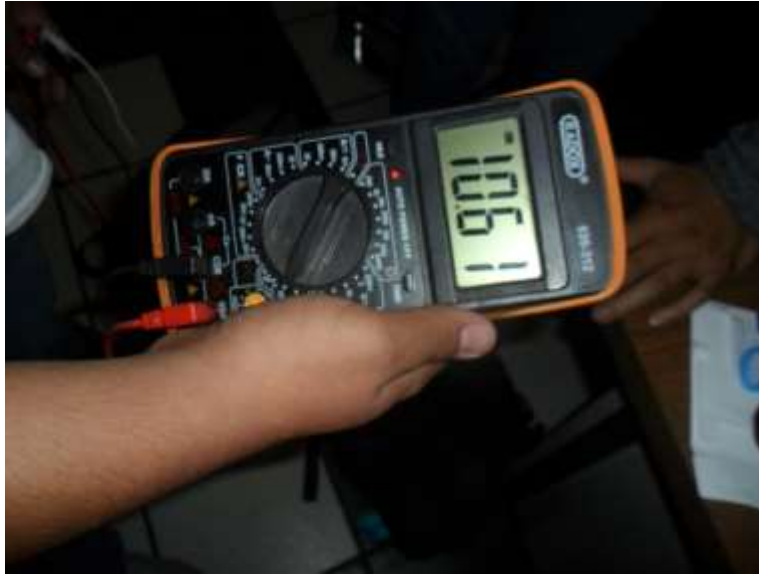
Figura 6 Comprobación del voltaje generado en corriente alterna
