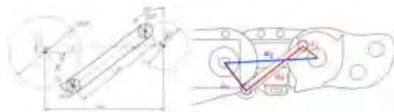
Figura 5. Mecanismo de 4 barras de la falange medial
