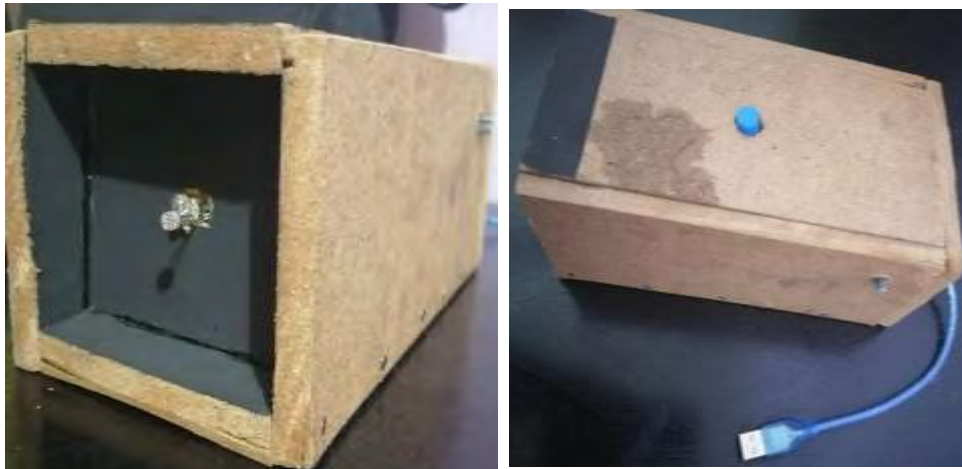
Figura 3. Cámara del sistema electrónico de medición de color RGB.
