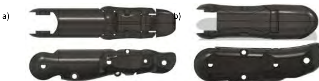
Figura 4. Diseño de falanges del dedo robótico a) índice y, b) pulgar.
