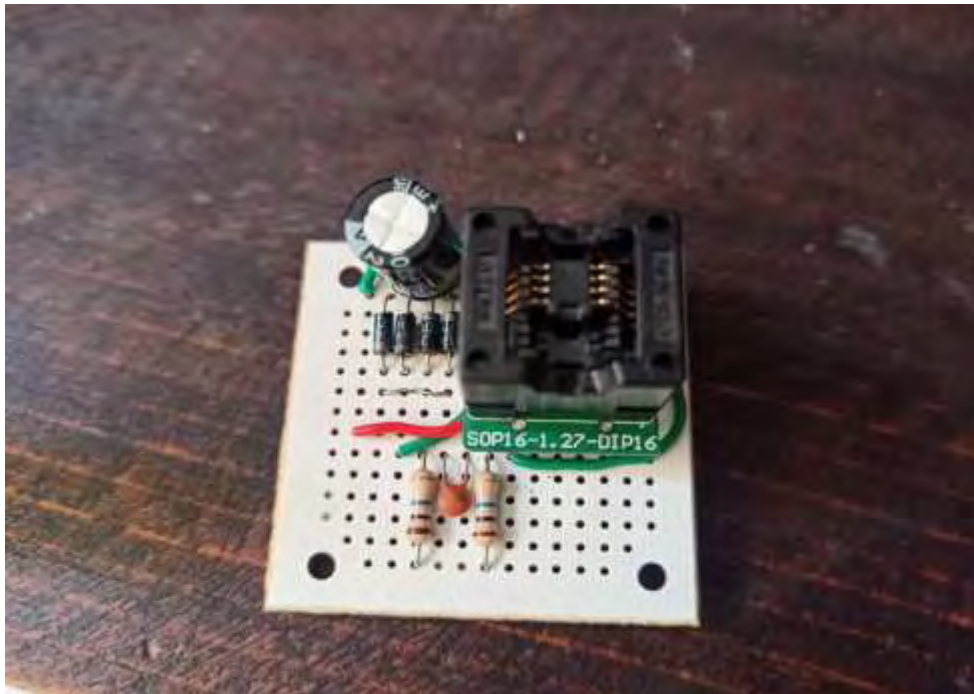
Figura 9 Tarjeta del circuito acondicionador de la señal del sensor piezoeléctrico.
