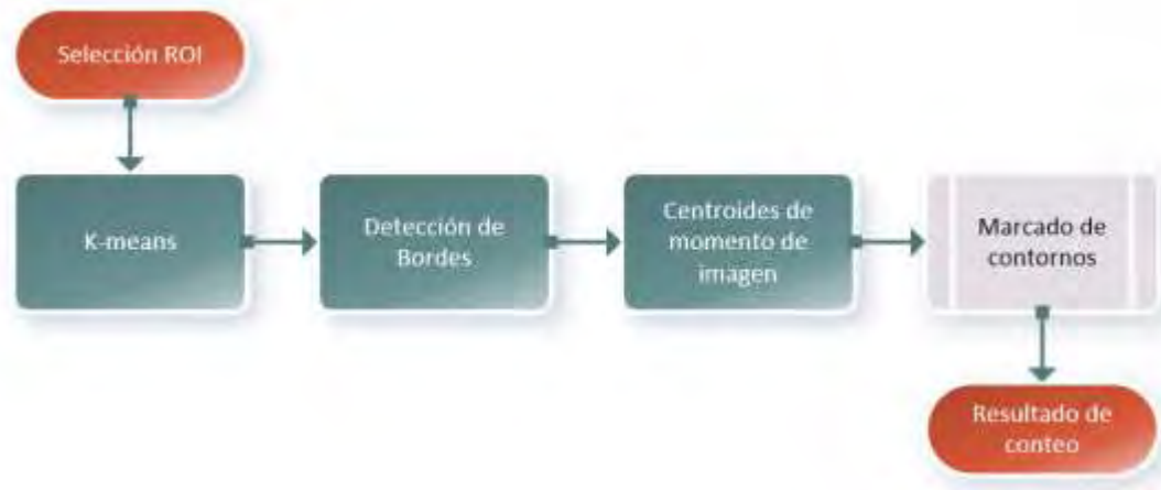
Figura 7. Procedimiento de segmentación, marcado, de bordes momentos y conteo.
