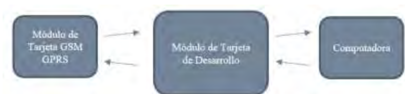
Figura 2. Diagrama de la conexión con el módulo de comunicación celular.
