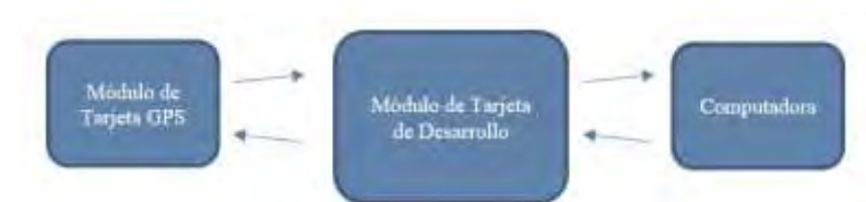
Figura 3. Diagrama de la conexión con el módulo de posicionamiento global.
