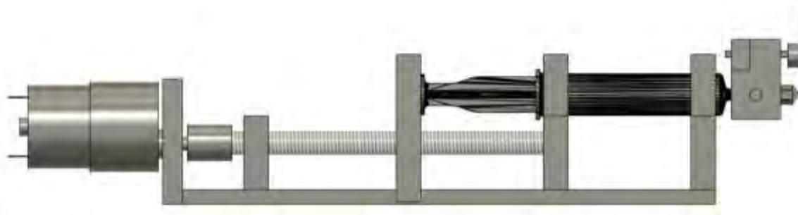
Figura 2. Modelo CAD del Sistema de coextrusión con cortador.
