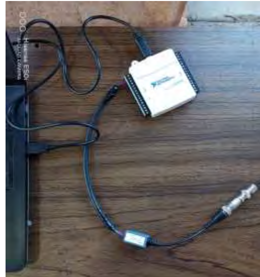
Figura 3. Conexión entre tarjeta NI USB 6009 y transductor PX35.
