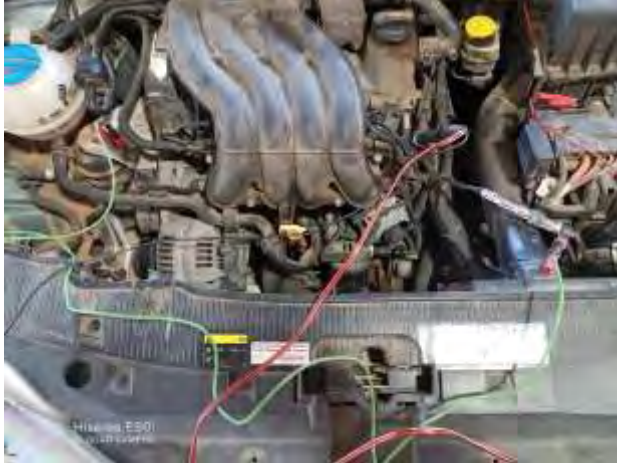
Figura 2. Instalación de transductor de presión.
