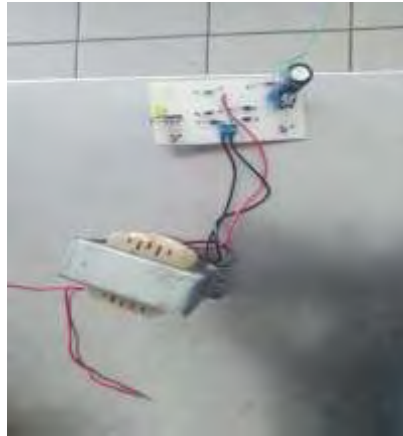
Figura 8. Fuente de salidas de 5 y 12 Vcd en placa.
