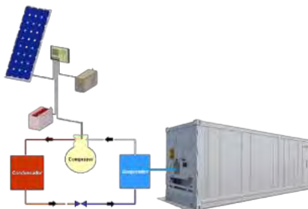
Figura 2: Sistema de Refrigeración
