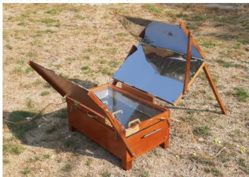
Figura 1. Estufa solar con reflectores externos.
