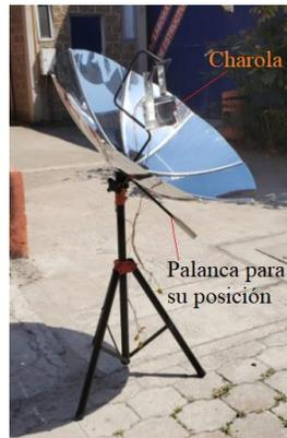
Figura 1. Estufa solar con reflectores externos.
