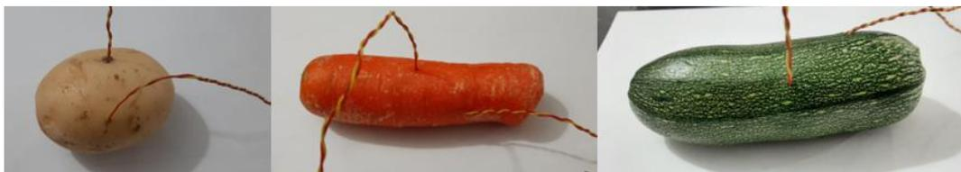
Figura 3. Disposición de los termopares en cada alimento
