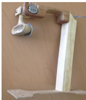
Figura 3. Anemómetro de empuje construido en madera utilizando un potenciómetro de 5k\Omega como sensor de posición.
