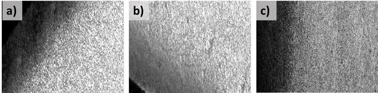
Figura 4. Microestructura del acero 12L14 cementado a 850°C con carbón vegetal, por a) 6 h, b) 8 h, y c) 10 h. Tomada a 50X y atacada químicamente con nital al 2%.
