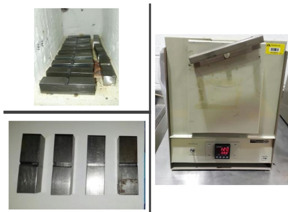
Figura 1. Geometría de las probetas de impacto Charpy, y el reelevado de esfuerzos al que fueron sometidas.
