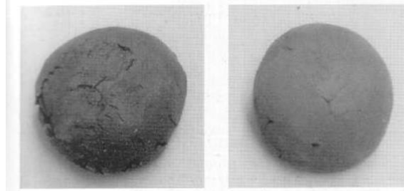
Ilustración 8.-Ensayo de caída de bola. Sirve para demostrar diferentes cohesividades. Fuente: Minke, G. (2005). Manual de construcción
