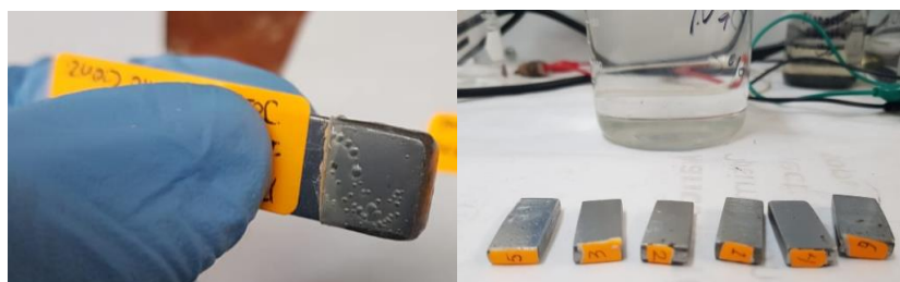
Figura 3. Probetas recubiertas con el polímero reforzado
