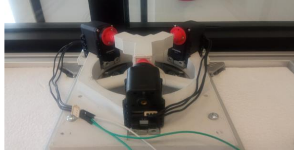
b) Motores que permiten la caracterización de la movilidad de una estructura deformable
