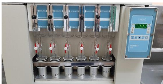
Figura 1. Equipo extractor de grasas y aceites
