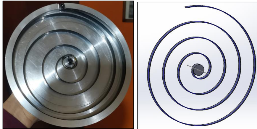
Figura 2. Modelo físico del KERS (izquierda) y modelo virtual (derecha)
