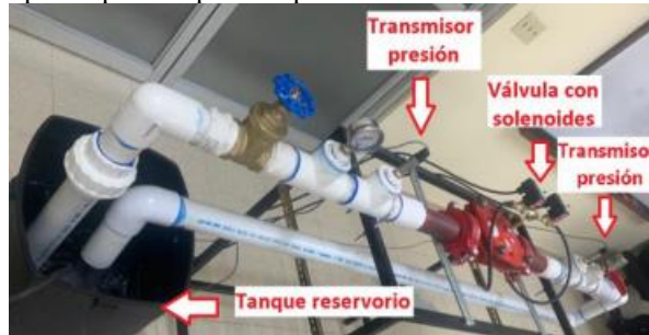
Figura 7. Prototipo funcional con válvula instalada, transmisores de presión y tanque de reservorio.
