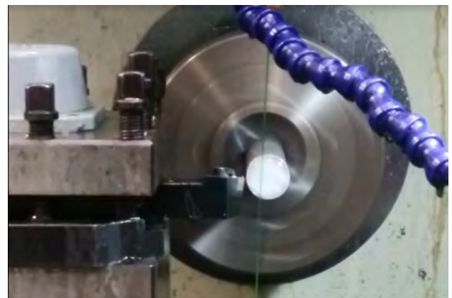
Figura.17 Careado del cilindro
