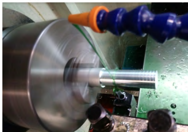
Figura.18 Desbaste de Cilindro.
