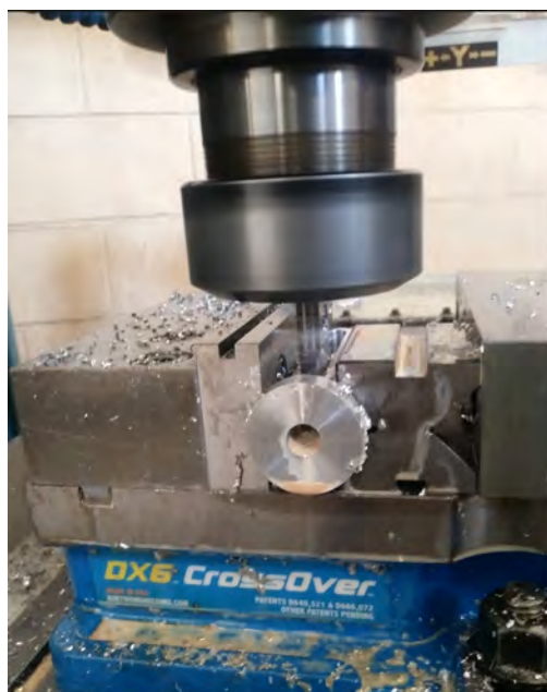
Figura.23 Perforacion de ranura.
