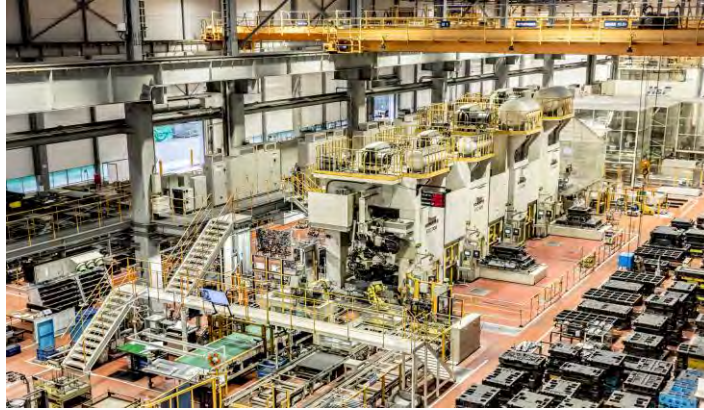
Figura 1. Líneas de producción de estampado usando prensas.
