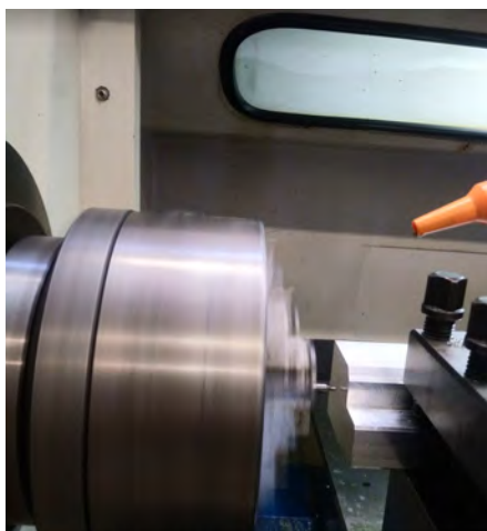
Figura.10 Inicio de Perforacion
