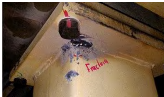
Figura 5. Aplicación de mantenimiento correctivo.
