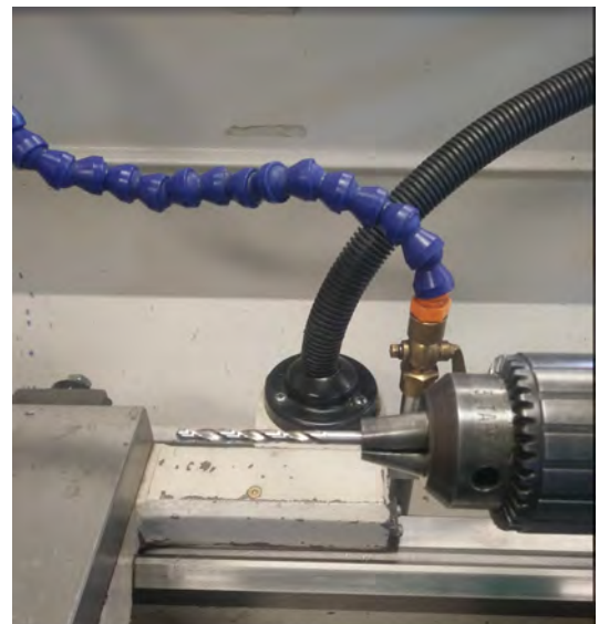
Figura.22 Perfocacion con broca.
