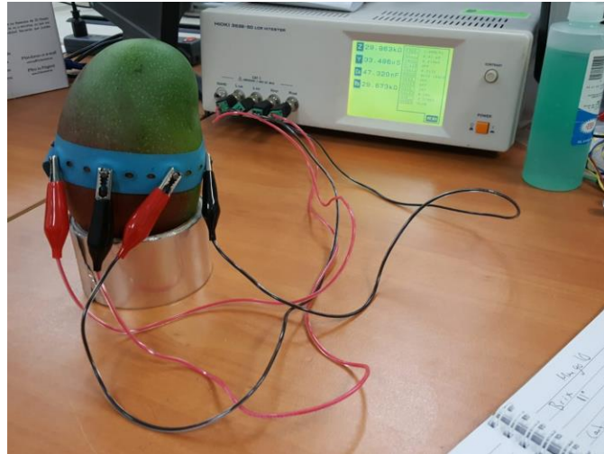
Figura 1. Configuración de la conexión de los electrodos en el mango al medidor de impedancia.
