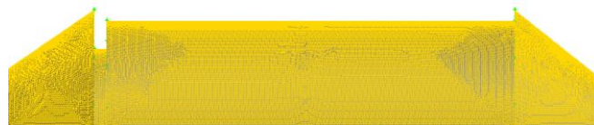
Figura 2. Malla de la cámara de combustión.
