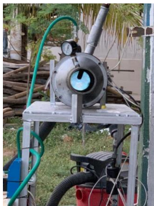
Figura 7. Foto frontal de la cámara de combustión encendida.
