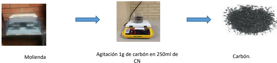
Figura 2 Adsorción de cianuro con carbón.
