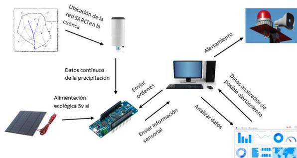
Figura 9. Modelado del sistema
