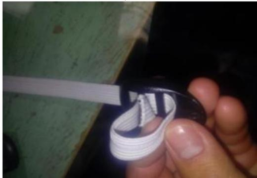
Figura 2. Colocación de resorte en el sujetador.
