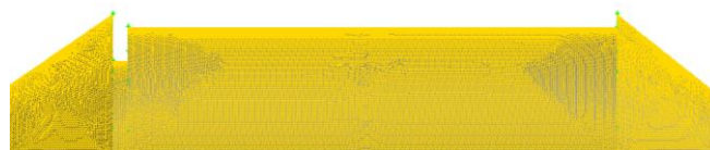
Figura 2. Malla de la cámara de combustión.
