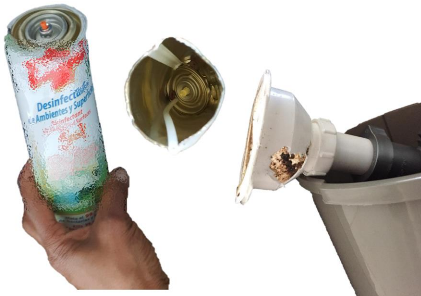
Figura 1. Explosión de un recipiente a presión que contenía un desinfectante. Se observa el daño causado a la tubería de la tarja que se ubicaba en el lugar donde se encontraba almacenado.
