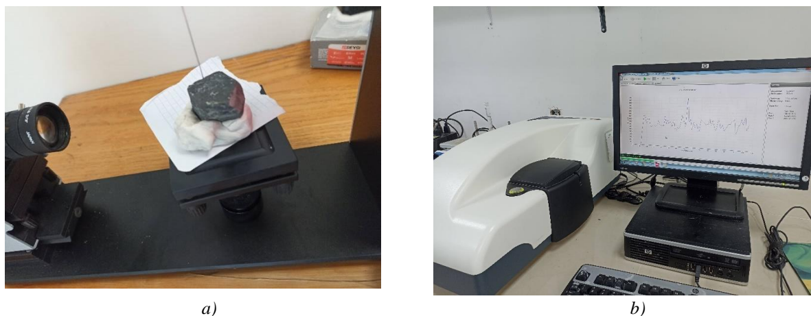
Figura 5. Elaboración de pruebas físico-químicas: a) Tensiómetro One Attention, prueba de ángulo de contacto, b) Equipo Zetasizer nano ZS9 Prueba de potencial Z.
