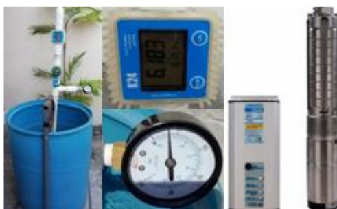
Figura 1. Sistema de bombeo solar.
