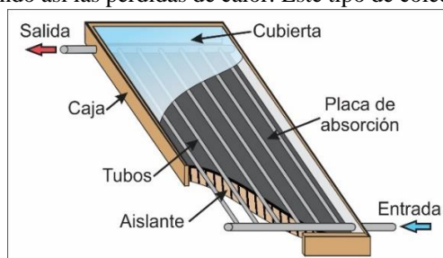
Figura 1. Colector solar de placa plana.
