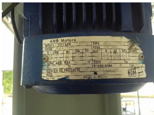
Figura 4. Placa de especificaciones de motor.
