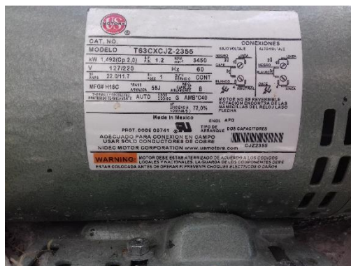
Figura 5. Placa de especificaciones de bomba.
