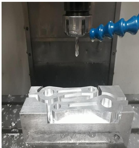
Imagen 3.- Maquinado en control numérico
