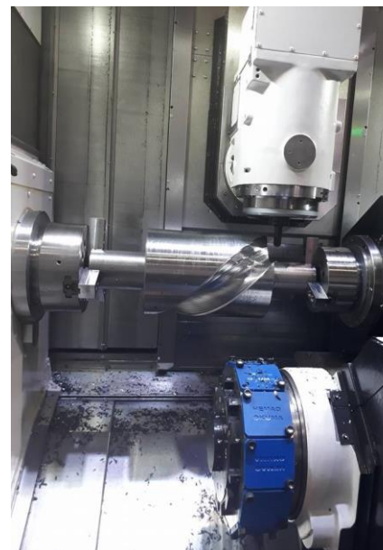
Imagen 4.- Maquinado con cuarto eje.
