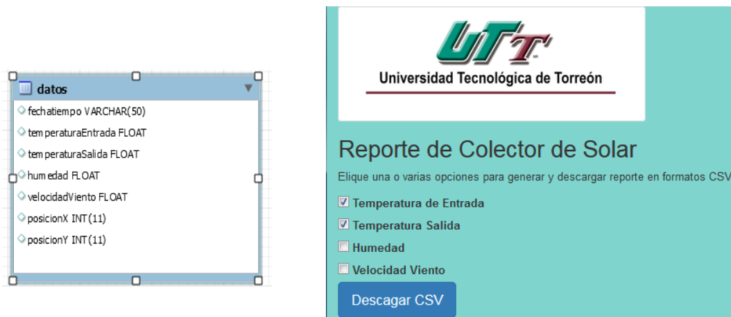
Figura 9. Estructura de base datos del sistema y pagina para generar reportes de variable medidas.
