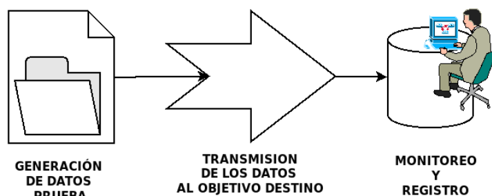
Figura 2. Modelo básico del fuzzer. Fuente: Elaboración propia.
