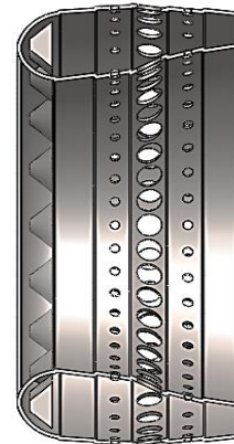
Figura 2. Vista lateral derecha, perfil C.C. del motor IAE V2500-A1.
