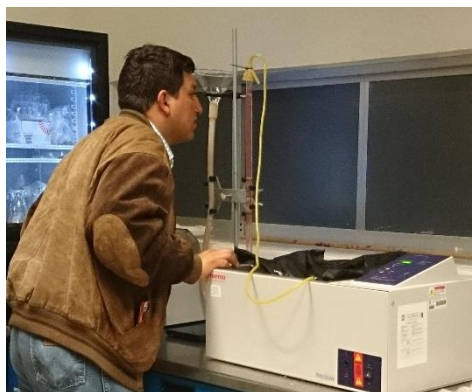
Figura 3. Medición del volumen de gas por desplazamiento de agua.
